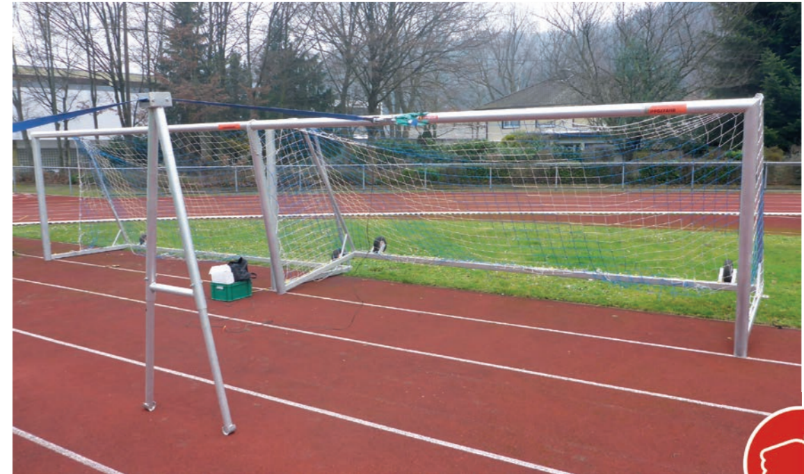
Bild 7: Wenn sich das Tor bei der Standfestigkeits- und Festigkeitsprüfung gemäß der sicherheitstechnischen Anforderungen nach DIN EN 748 hebt, ist die Standfestigkeit nicht ausreichend.
