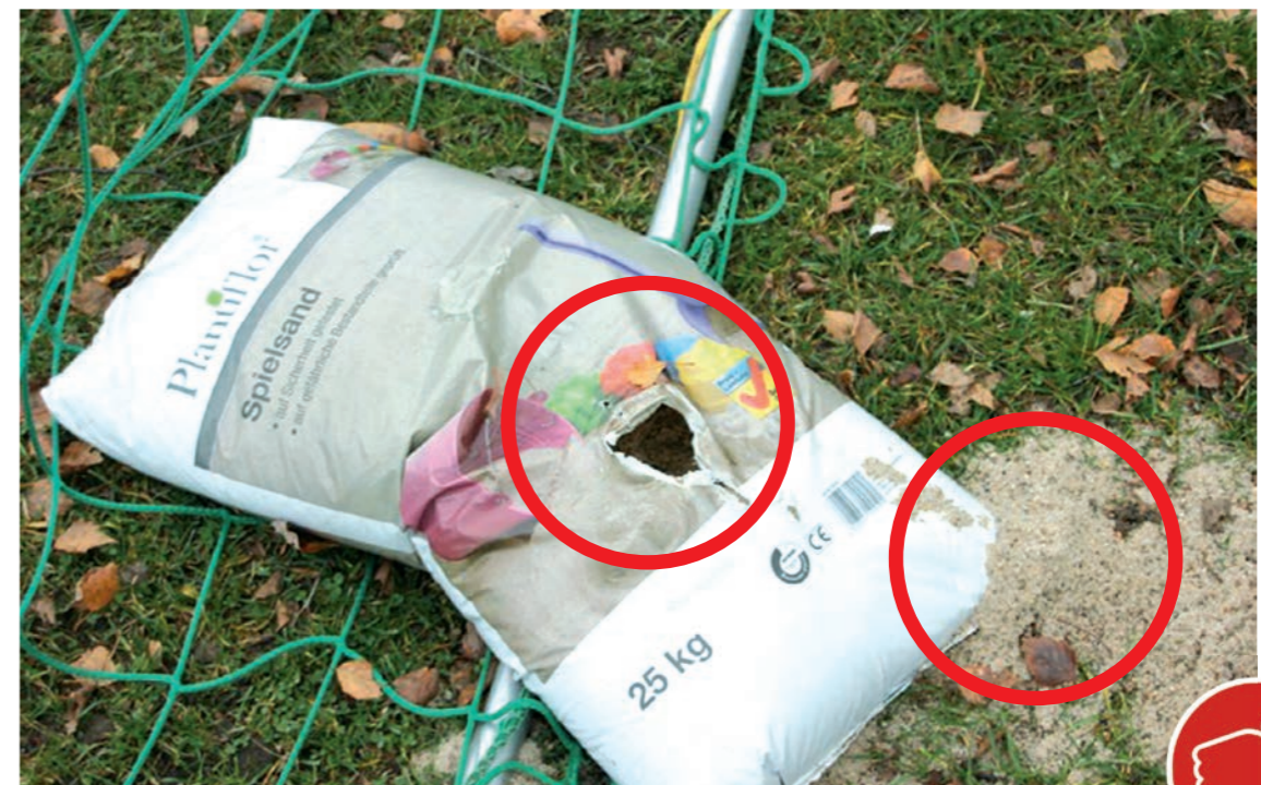
Bild 10: Sandsäcke sind nicht geeignet, um Tore dauerhaft gegen Umkippen zu sichern.
