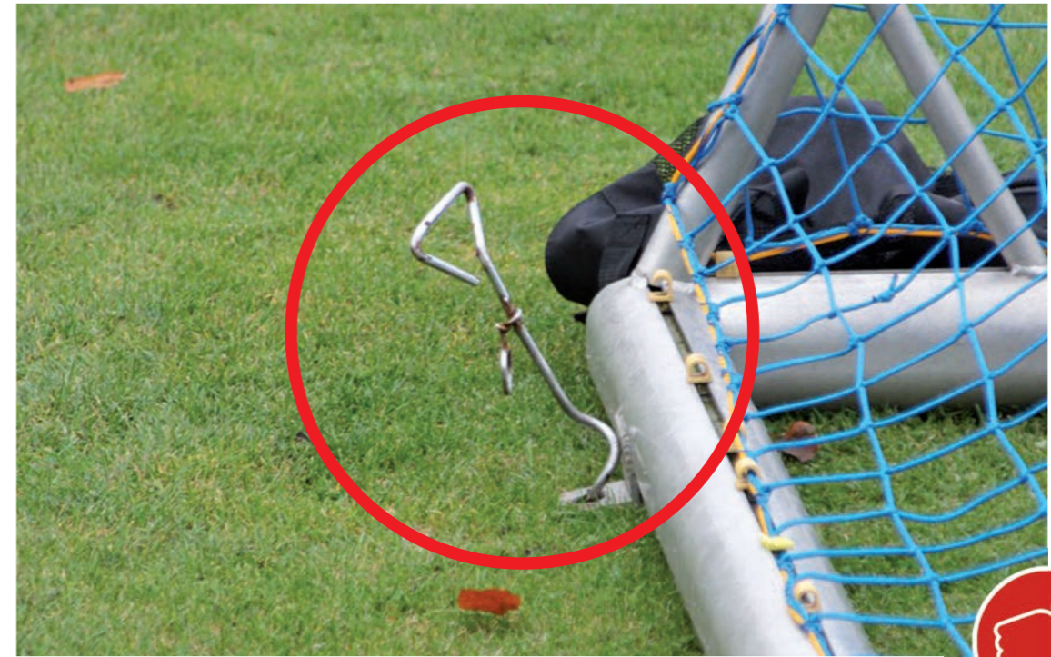
Bild 9: Überstehender, nicht vollständig eingeschraubter Spiralanker
