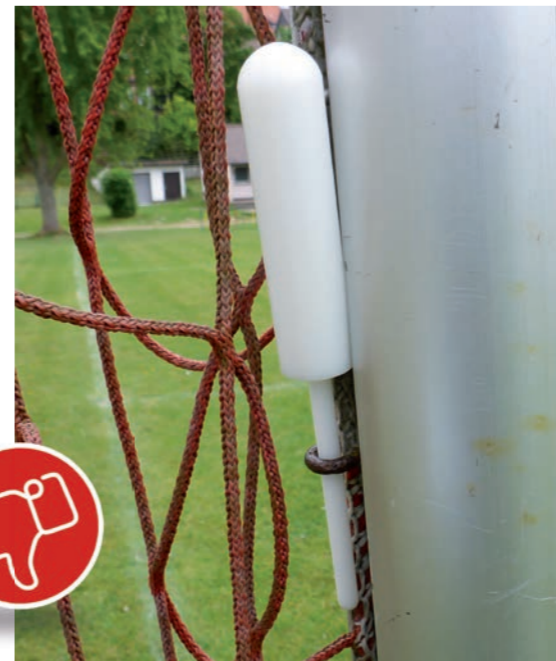
Bild 34: Die kleine Seite des Prüfstabes passt in die Öffnung, d.h. diese ist größer als 8 mm, aber eindeutig kleiner als 25 mm und daher nicht zulässig.
