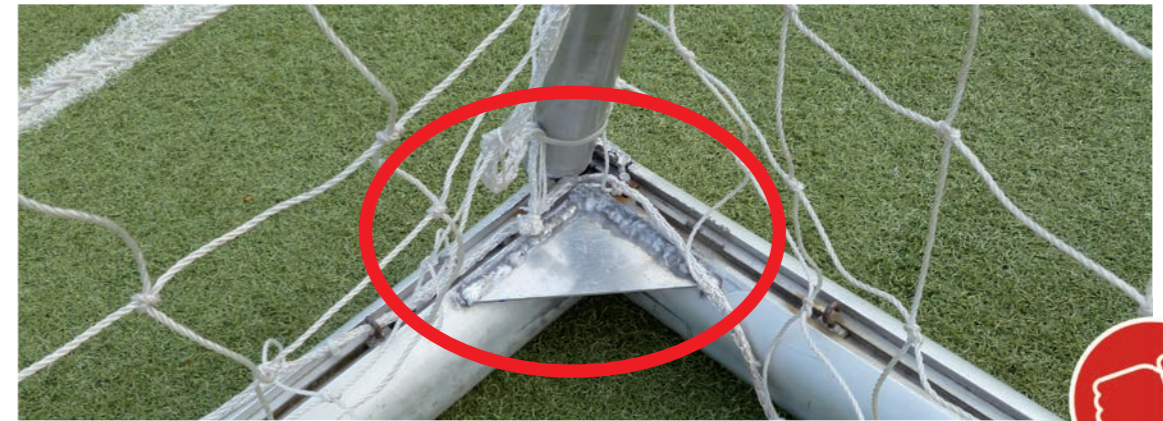
Bild 28: Eingeschweißter Winkel stellt erhöhte Verletzungsgefahr dar
